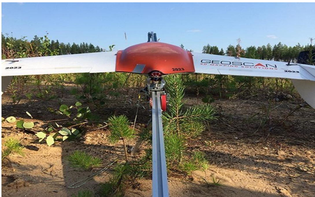
2.1 - сурет – Geoscan 201 катапульттан ұшу алдындағы көрінісі
